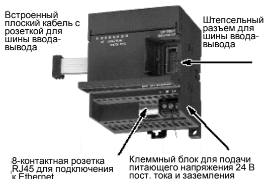
Рис. А–37. Подключение модуля Ethernet (CP 243-1)
